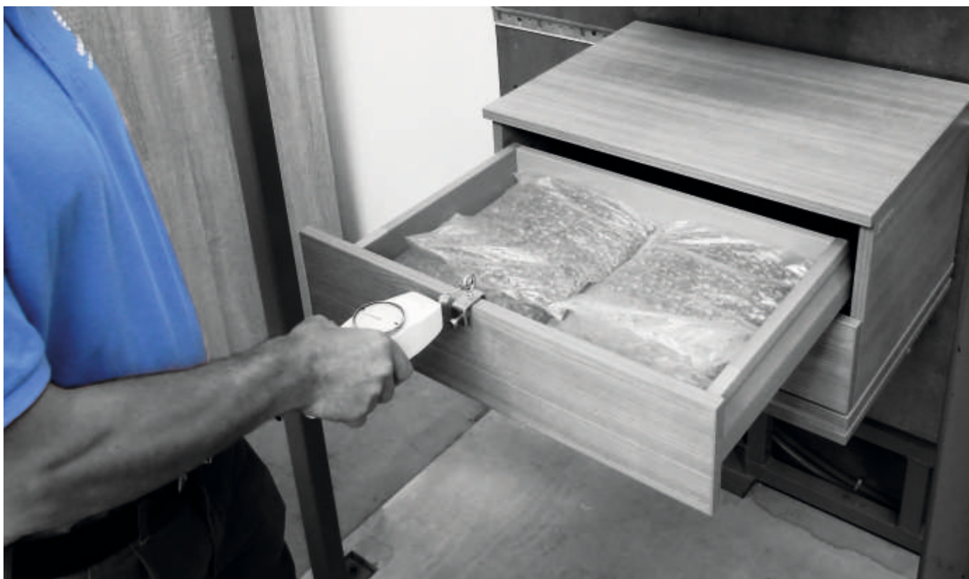
Тест на перевірку механізму закривання у навантаженому шухляді
