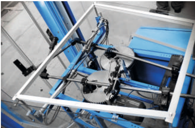
Спеціальні тести надійності – 20 000 циклів відкривання і закривання дверей
