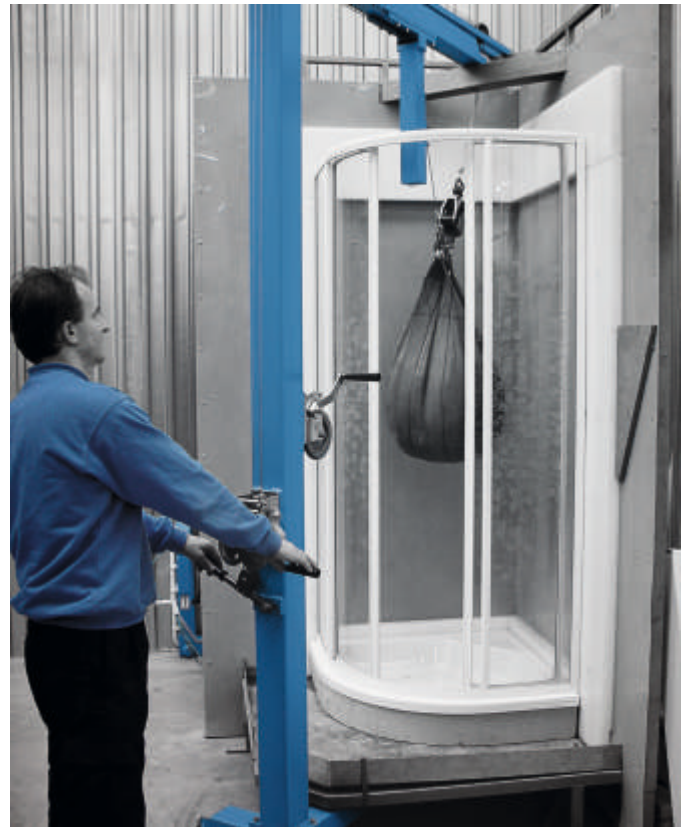
Тести на міцність конструкції кабін.
